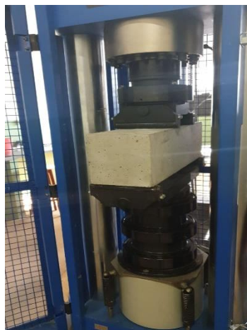
Figura 10 – Prensa Hidráulica Ensaio de Tração na Flexão Fonte: Próprio autor (2019).
