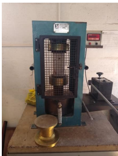
Figura 7 – Prensa Hidráulica Ensaio de Compressão Fonte: Próprio autor (2019).
