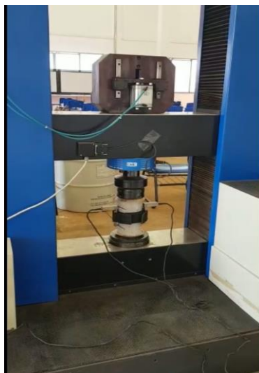
Figura 8 – Ensaio de módulo de elasticidade Fonte: Próprio autor (2019).
