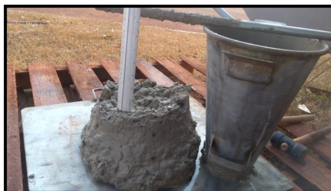
Figura 6 – Abatimento traço referência Fonte: Próprio autor (2019).
