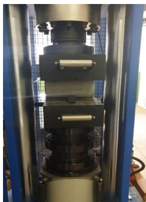
Figura 9 – Prensa Hidráulica Ensaio de Tração por Compressão Diametral Fonte: Próprio autor (2019).
